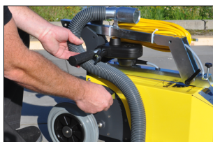
Leichtes Einrichten der Maschine über Neigungsmechanik + Libelle.
