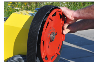
Flexibel gelagerte Antriebswelle.
