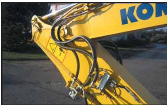
Zusätzliche Hydraulikkreisläufe Eine zusätzliche 2-Wege-Hydraulikfunktion, vom Joystick aus elektrisch zu bedienen, ist im Standardlieferungsumfang enthalten.
