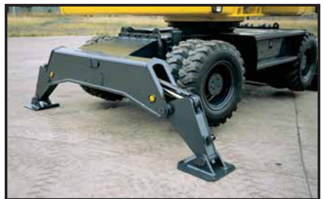
Pratzen Die vorderen und hinteren Pratzen lassen sich auch unabhängig steuern. Der Hydraulikzylinderschutz an den Pratzen ist Standard.
