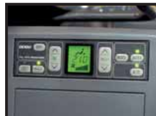
Klimatronic mit Umluft- und Defrosterbetrieb
