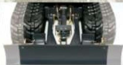
Durch die einfache Demontage von jeweils einem Verriegelungsbolzen, werden die nach innen einklappbaren Seitenteile des Planierschilds, entsprechend der Fahrwerksbreite angepasst.
