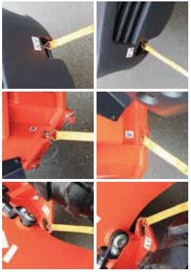
Mit einer Gesamthöhe von unter 2500 mm kann der R070 und R090 schnell und sicher zwischen zwei Bauten transportiert werden. Sechs Festigkeitspunkte erlauben das Verzurren auf einem Tiefdach und ermöglichen ein zügiges Umsetzen der Maschine.
