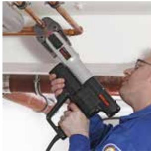
**Robuste, kompakte Elektro-Radialpresse mit automatischem Rücklauf (Zwangsablauf). Für Radial-Pressverbindungen Ø 10–108 (110) mm.**
